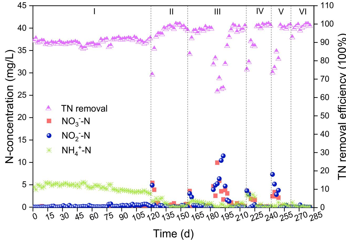
TN removal efficiency >90%; Effluent NO<sub>3</sub><sup>-</sup> concentrations <0.5 mg/L.
